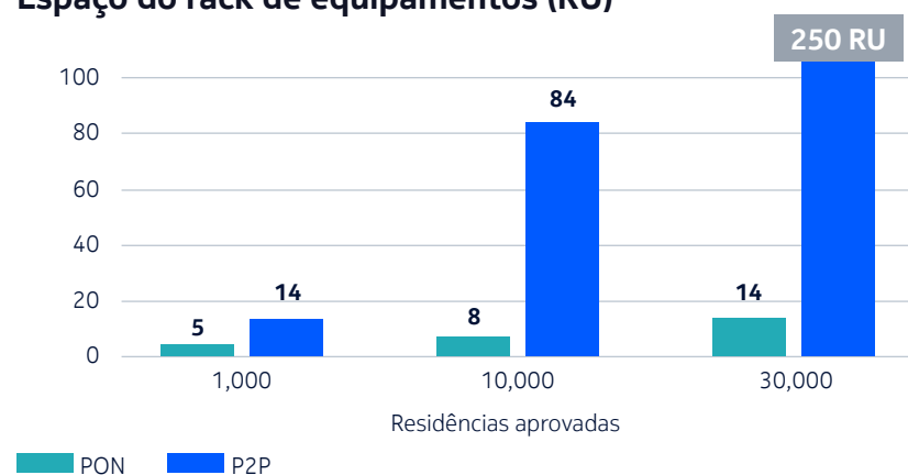
Espaço do rack de equipamentos (RU)
