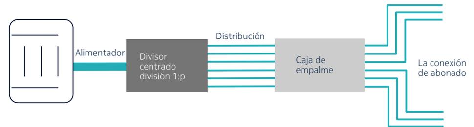
Figura 7 Arquitectura PON dividida centralizada
