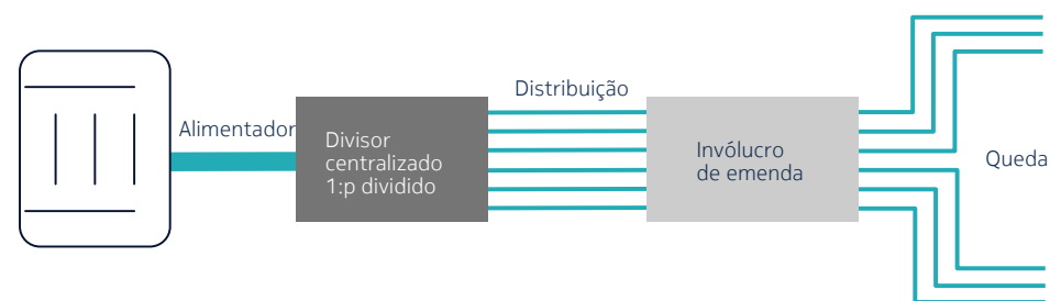
Figura 7. Arquitetura da PON dividida centralizada
